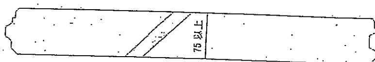
意匠パネルの例（溝加工した残り寸法が75mm以上のもの）
