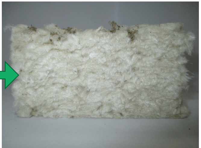
断面 内部への侵入なし
