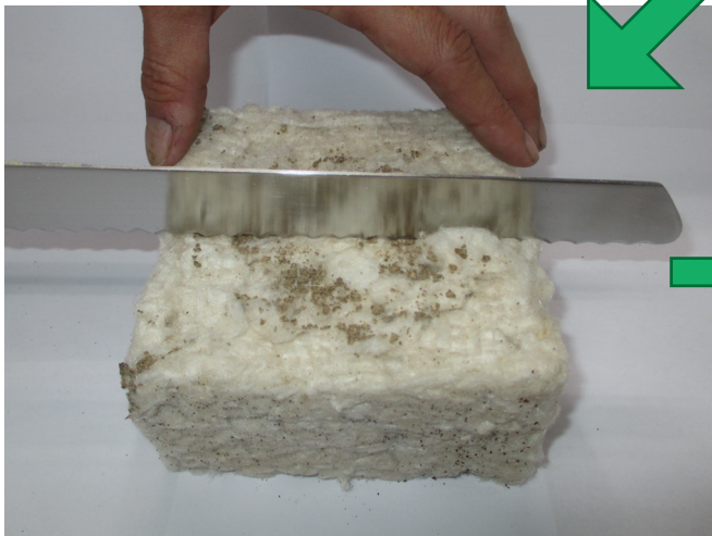
シロアリの内部侵入確認
